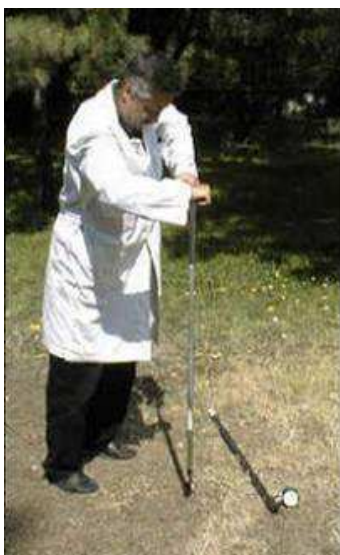
Рис. №2.3.: Установка тензиометра
